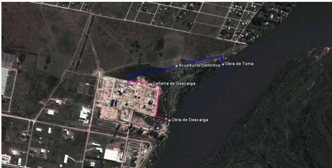
**Figura 64.** Identificación de obras complementarias a la CTBL ligadas a la ampliación a ciclo combinado.
