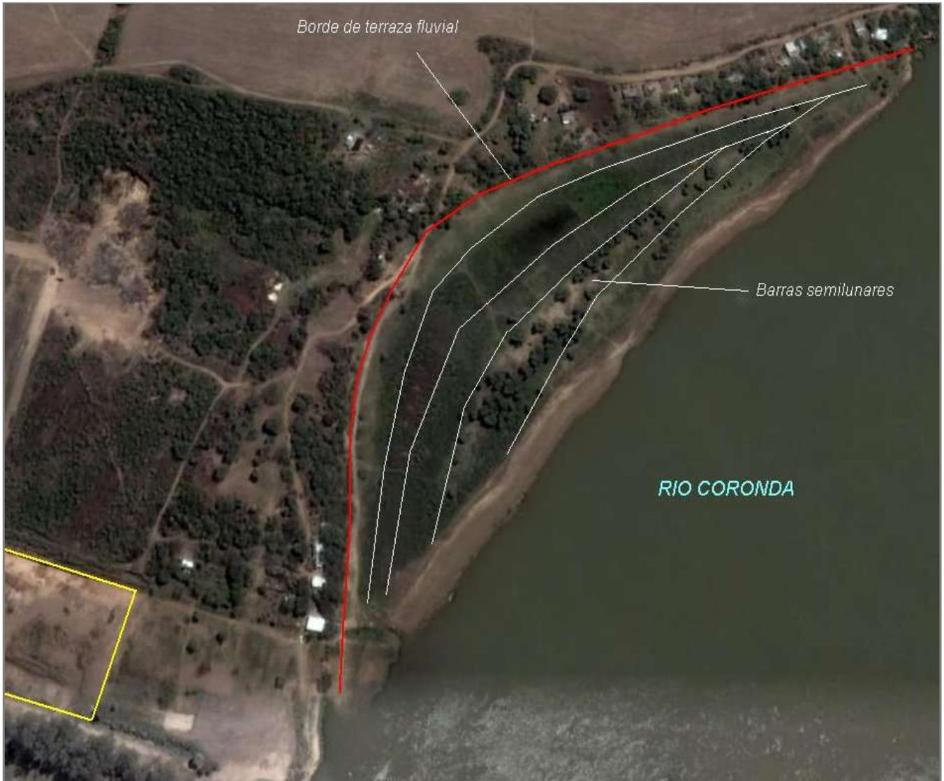
**Figura 49.** En el extremo izquierdo de la imagen se observa el límite Oriental del predio de la Central. En trazo rojo se indica el borde de la terraza inferior y sobre ella la secuencia de barras de punta o albardones semilunares. Tomado de Serman & Asociados S.A. (2009).
