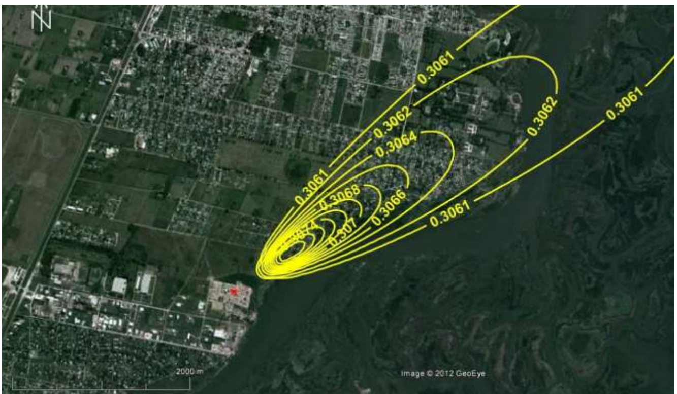
Figura 5. Isopletras de concentración media en \text{mg/m}^3 (tiempo promedio 20 minutos) de MP 10 en aire a nivel del suelo. Combustible: gas natural. (02/03/04, 05:00-05:20hs). * Chimenea.
