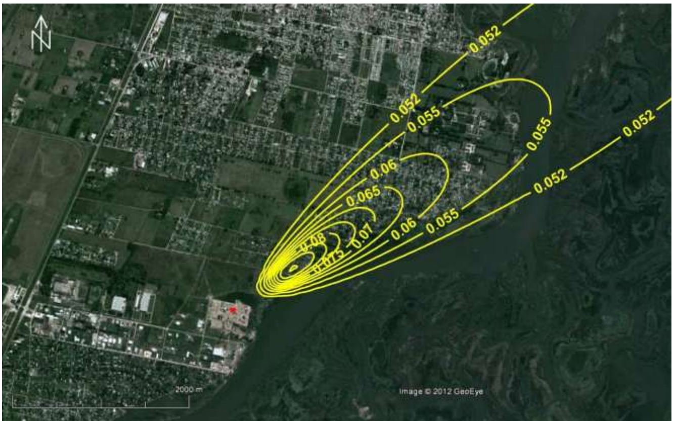
Figura 9. Isopletas de concentración media en \text{mg/m}^3 (tiempo promedio 20 minutos) de \text{NO}_x (expresados como \text{NO}_2 ) en aire a nivel del suelo. Combustible: combustible líquido. (02/03/04, 05:00-05:20hs). * Chimenea.
