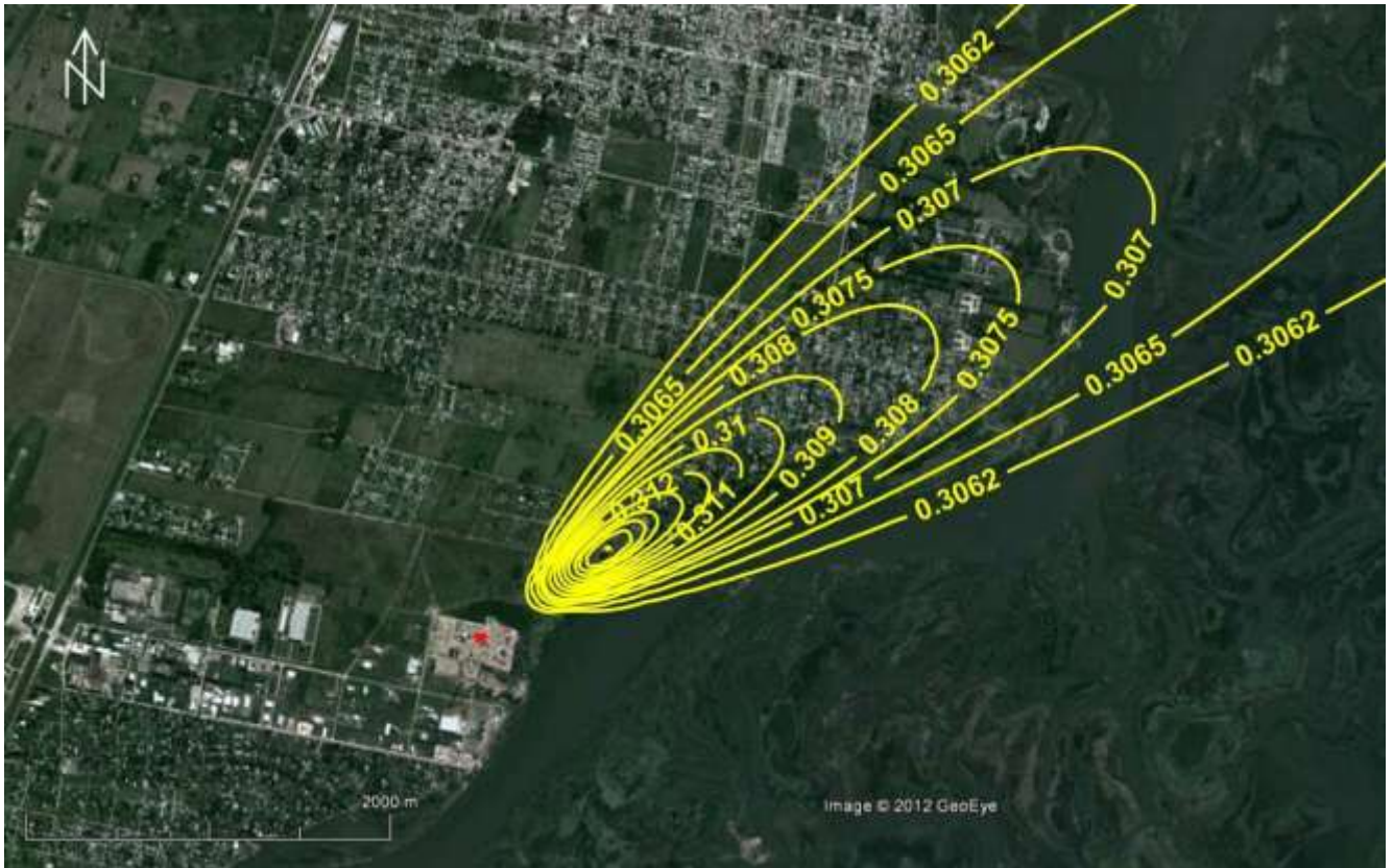
Figura 13. Isopletas de concentración media en \text{mg}/\text{m}^3 (tiempo promedio 20 minutos) de material particulado en suspensión PM-10 en aire a nivel del suelo. Combustible: fuel-oil. (02/03/04, 05:00-05:20hs). * Chimenea.
