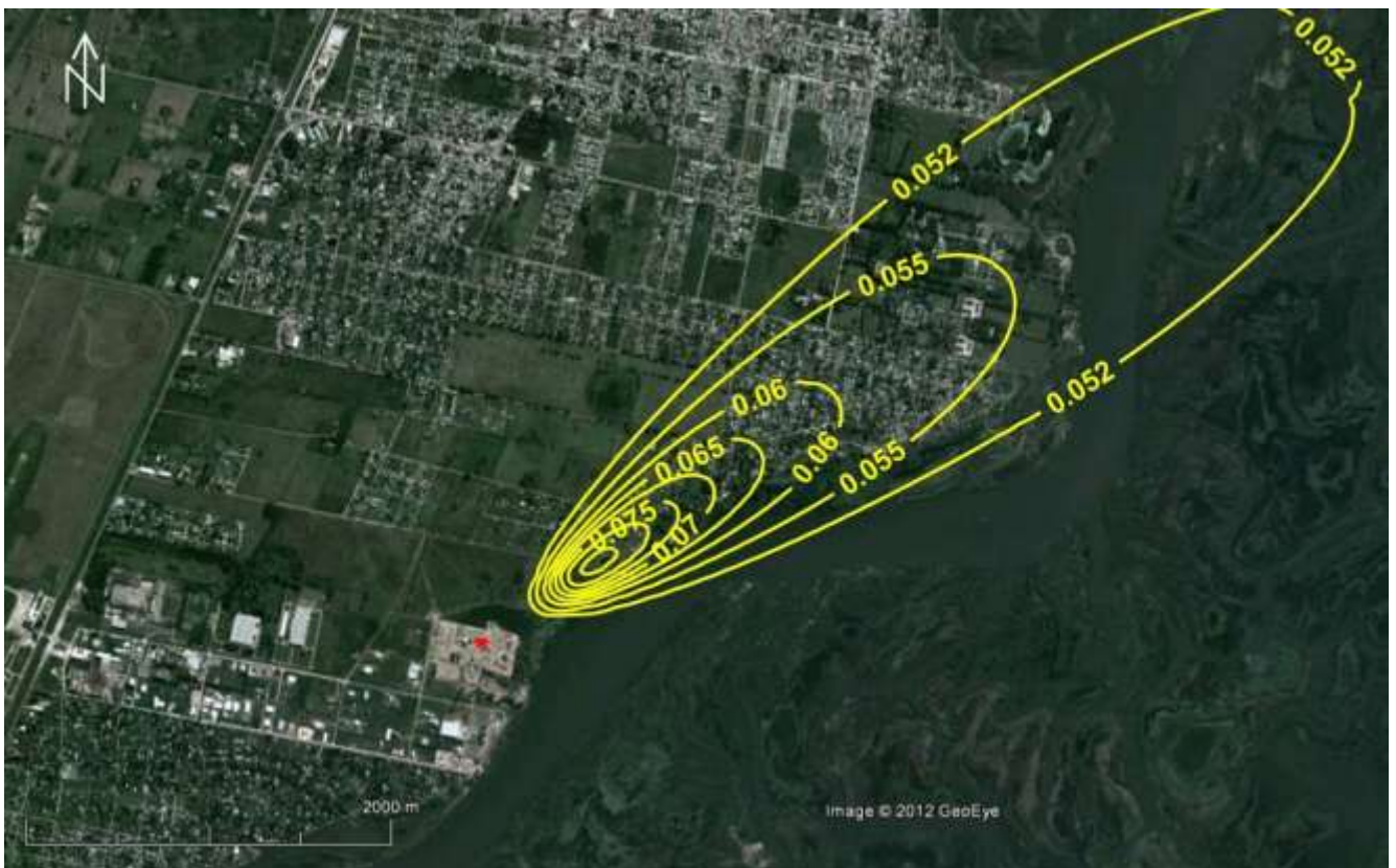
Figura 3. Isopletas de concentración media en \text{mg/m}^3 (tiempo promedio 20 minutos) de \text{NO}_x (expresados como \text{NO}_2 ) en aire a nivel del suelo. Combustible: gas natural. (02/03/04, 05:00-05:20hs). * Chimenea.
