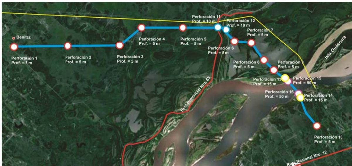
**Figura 3 - Pág. 21:** Detalle de perforaciones a realizar en márgenes de Río Paraná
