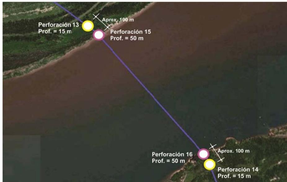
**Figura 4 - Pág. 22:** Detalle de perforaciones a realizar en márgenes de Riacho Ancho
