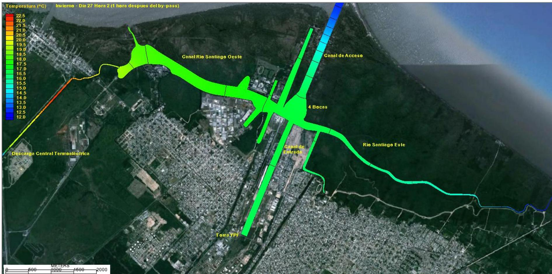
**Figura 39.** Descarga de agua con Incremento de Temperatura 7,5°C - Marea media. Escenario de Invierno (temp. de equilibrio 12,2°C) y Coeficiente de Transferencia de calor mínimo. Campo de temperaturas una hora después de la descarga en bypass de turbina con Incremento de Temperatura 11,5° durante 1 hora.
