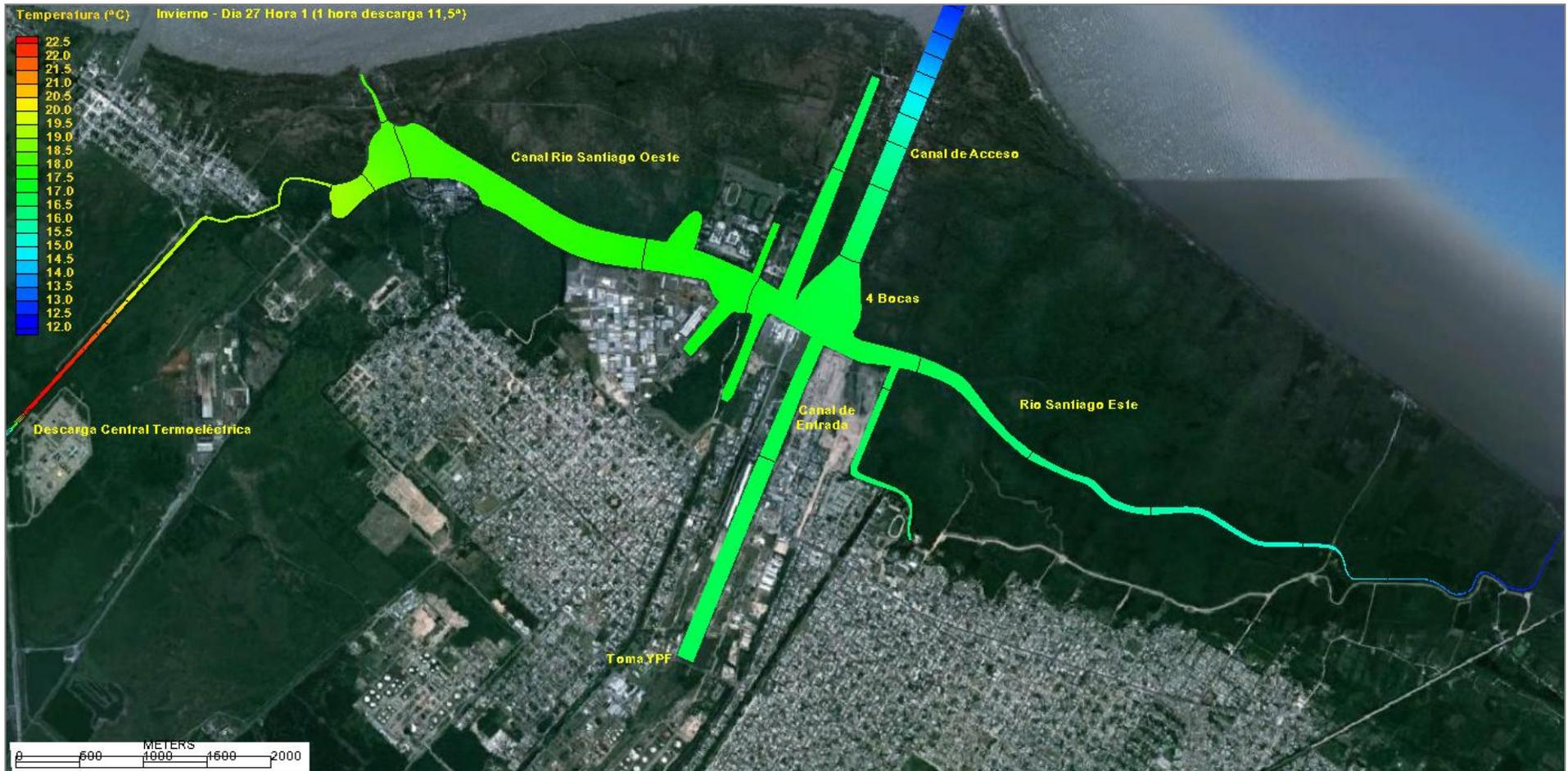
**Figura 38.** Descarga de agua con Incremento de Temperatura 7,5°C - Marea media. Escenario de Invierno (temp. de equilibrio 12,2°C) y Coeficiente de Transferencia de calor mínimo. Campo de temperaturas al final de la descarga en bypass de turbina con Incremento de Temperatura 11,5°C durante 1 hora.
