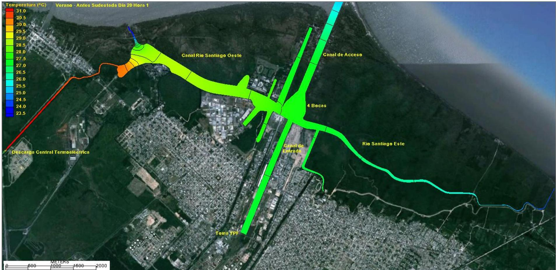
**Figura 50.** Descarga de agua con Incremento de Temperatura 7,5°C - Marea astronómica con Sudestada. Escenario de Verano (temp. de equilibrio 23,5°C) y Coeficiente de Transferencia de calor mínimo. Campo de temperaturas típico antes de la Sudestada y después de una descarga en bypass de turbina con Incremento de Temperatura 11,5°C durante 1 hora (primer bypass en 24 horas).
