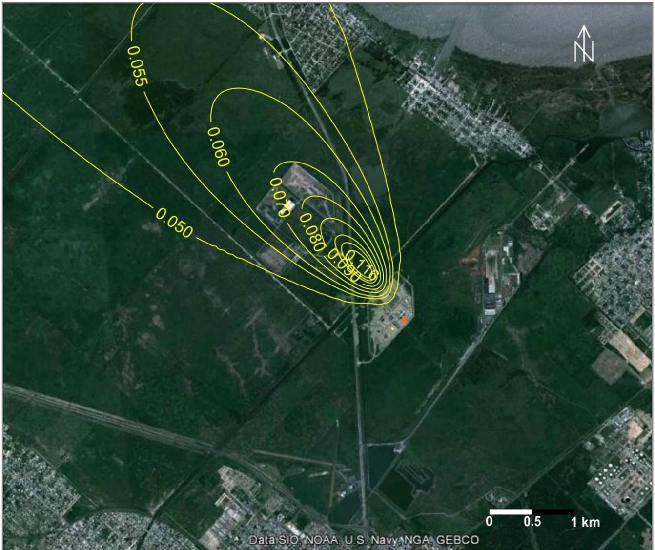
**Figura 9.** Isoplethas de concentración media en  $\text{mg}/\text{m}^3$  (tiempo promedio 1 hora) de  $\text{NO}_x$  (expresados como  $\text{NO}_2$ ) en aire a nivel del suelo. Combustible: combustible líquido. (10/01/2005; 1:00 hs). ▲ Chimenea 01.
