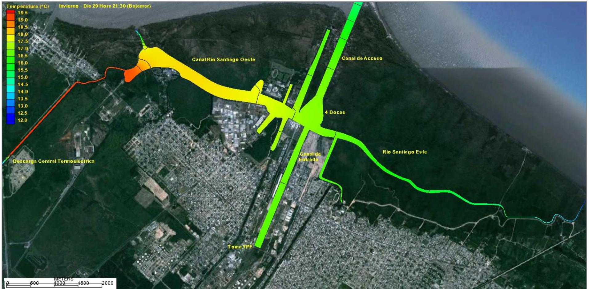
Figura 44. Descarga de agua con Incremento de Temperatura 7,5°C - Marea media. Escenario de Invierno (temp. de Equilibrio 12,2°C) y Coeficiente de Transferencia de calor mínimo. Campo de temperaturas típico en cercanías de una Bajamar.
