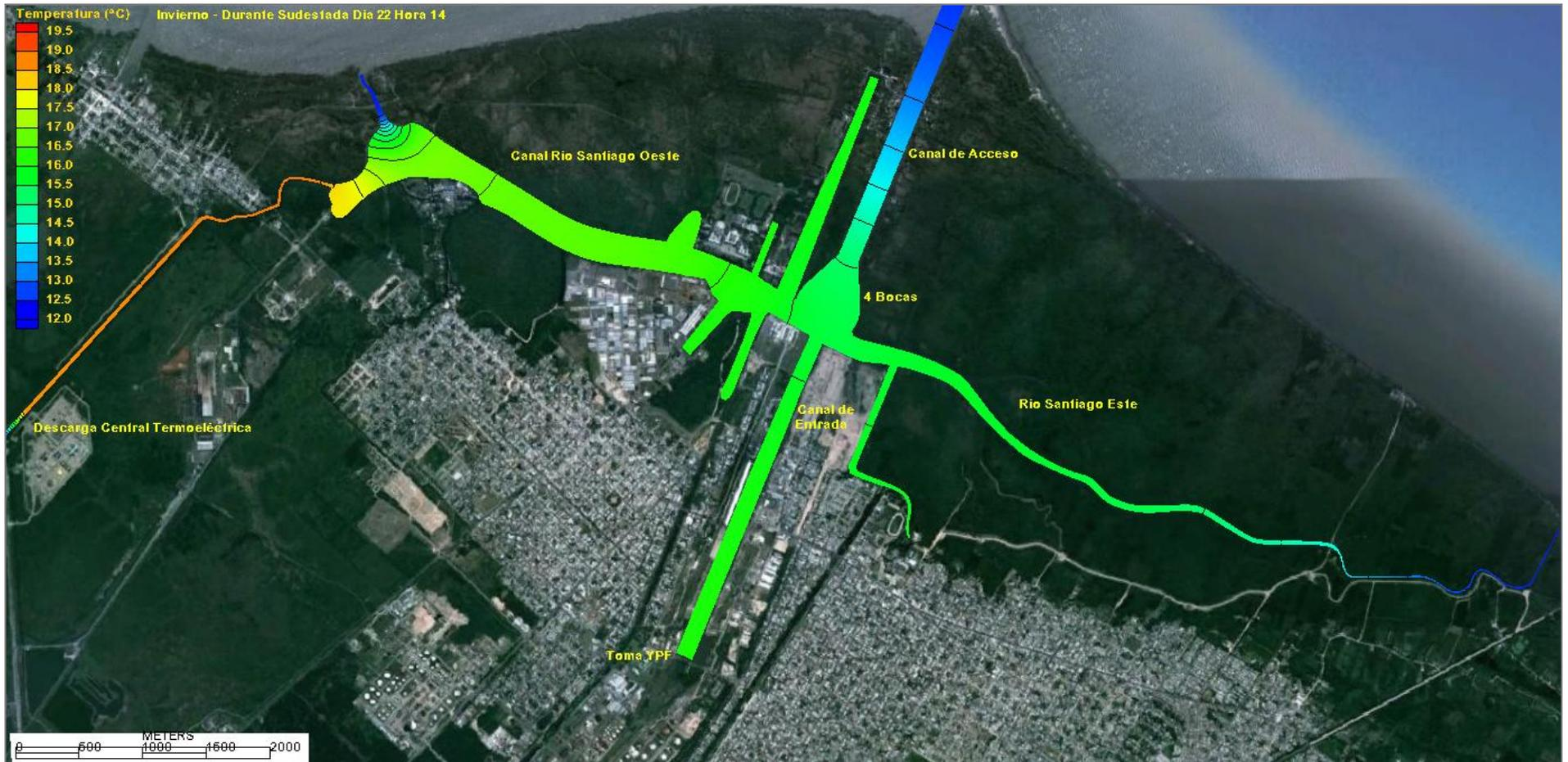
**Figura 48.** Descarga de agua con Incremento de Temperatura 7,5°C - Marea astronómica con Sudestada. Escenario de Invierno (temp. de equilibrio 12,2°C) y Coeficiente de Transferencia de calor mínimo. Campo de temperaturas típico durante el pico de pleamar de la Sudestada.
