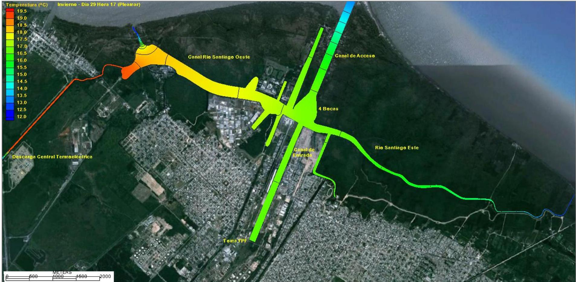
**Figura 43.** Descarga de agua con Incremento de Temperatura 7,5°C - Marea media. Escenario de Invierno (temp. de Equilibrio 12,2°C) y Coeficiente de Transferencia de calor mínimo. Campo de temperaturas típico en cercanías de una Pleamar.
