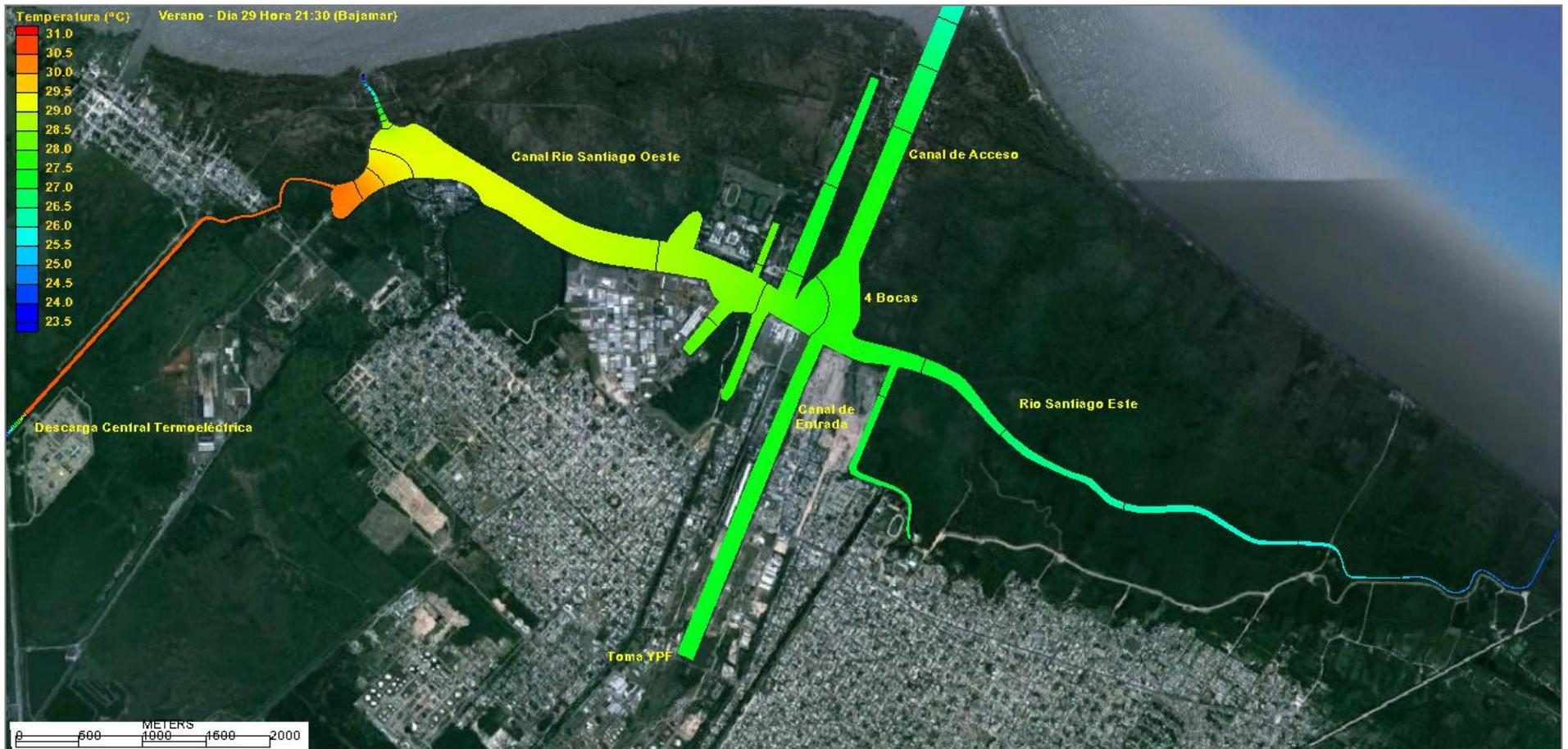
**Figura 47.** Descarga de agua con Incremento de Temperatura 7,5°C - Marea media. Escenario de Verano (temp. de equilibrio 23,5°C) y Coeficiente de Transferencia de calor máximo. Campo de temperaturas típico en cercanías de una Bajamar.
