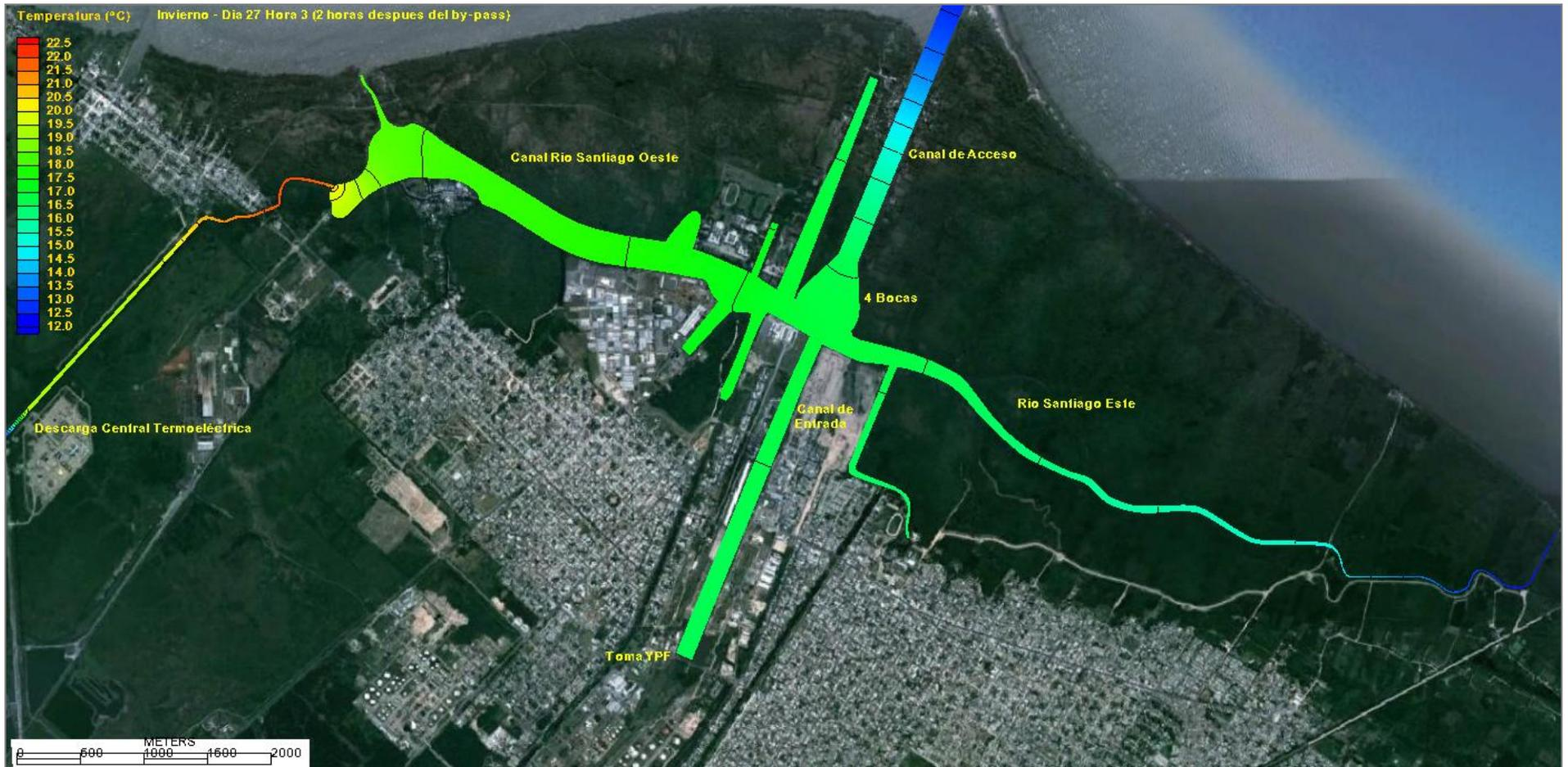
**Figura 40.** Descarga de agua con Incremento de Temperatura 7,5°C - Marea media. Escenario de Invierno (temp. de equilibrio 12,2°C) y Coeficiente de Transferencia de calor mínimo. Campo de temperaturas dos horas después de la descarga en bypass de turbina con Incremento de Temperatura 11,5°C durante 1 hora.
