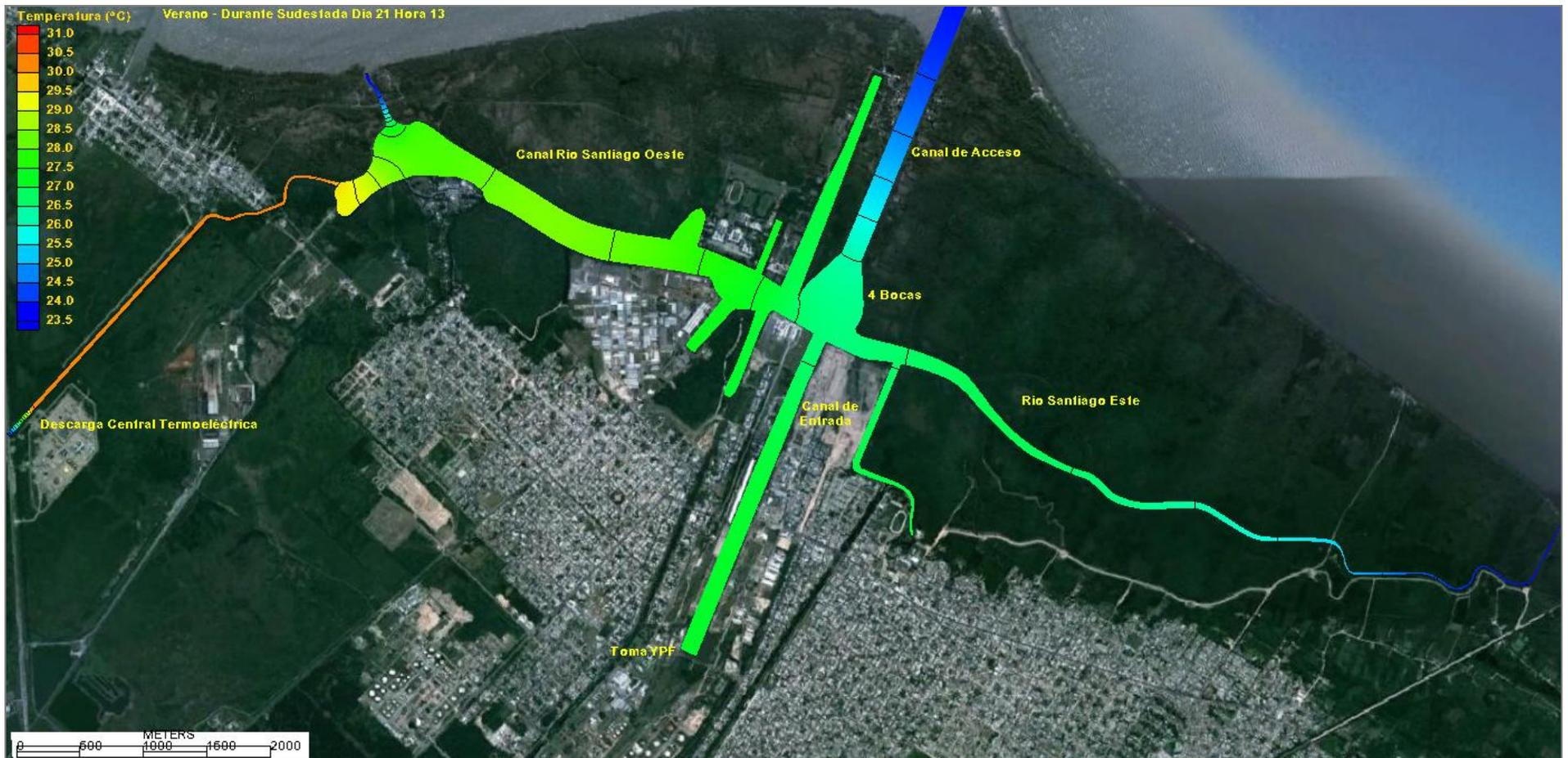
**Figura 54.** Descarga de agua con Incremento de Temperatura 7,5°C - Marea astronómica con Sudestada. Escenario de Verano (temp. de Equilibrio 23,5°C) y Coeficiente de Transferencia de calor mínimo. Campo de temperaturas típico durante la Sudestada (marea creciente) 12 horas después de la descarga en bypass de turbina con Incremento de Temperatura 11,5°C durante 1 hora.
