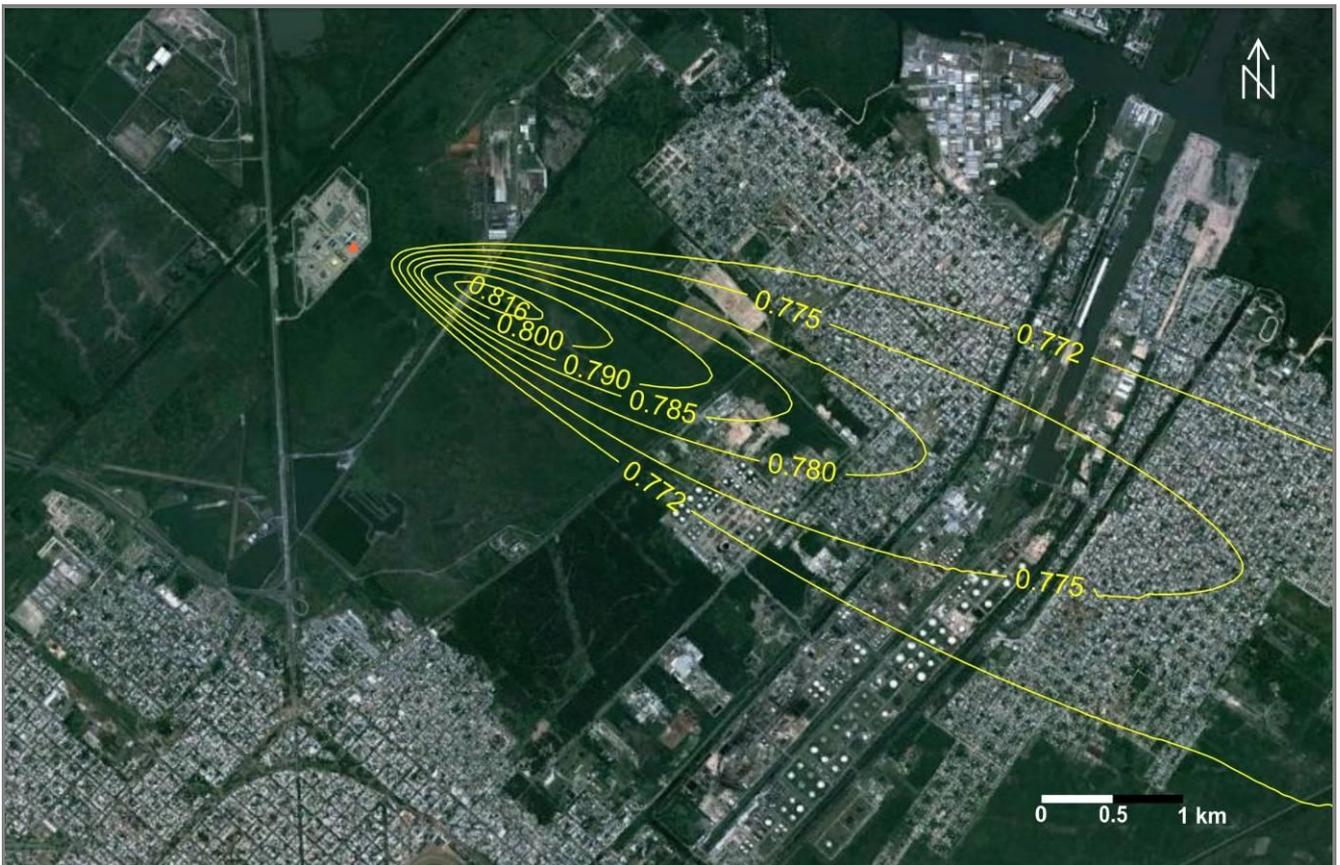
**Figura 8.** Isopletas concentración media en mg/m<sup>3</sup> (tiempo promedio 8 horas) de CO en aire a nivel del suelo. Combustible: combustible líquido. (5/10/2005; entre las 8:00 hs y las 16:00 hs). ▲ Chimenea 01.
