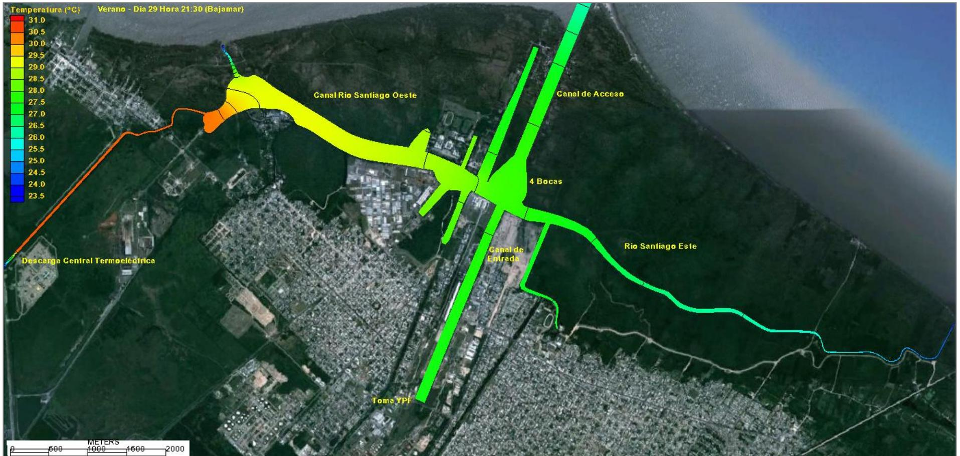
Figura 46. Descarga de agua con Incremento de Temperatura 7,5°C - Marea media. Escenario de Verano (temp. de equilibrio 23,5°C) y Coeficiente de Transferencia de calor mínimo. Campo de temperaturas típico en cercanías de una Bajamar.
