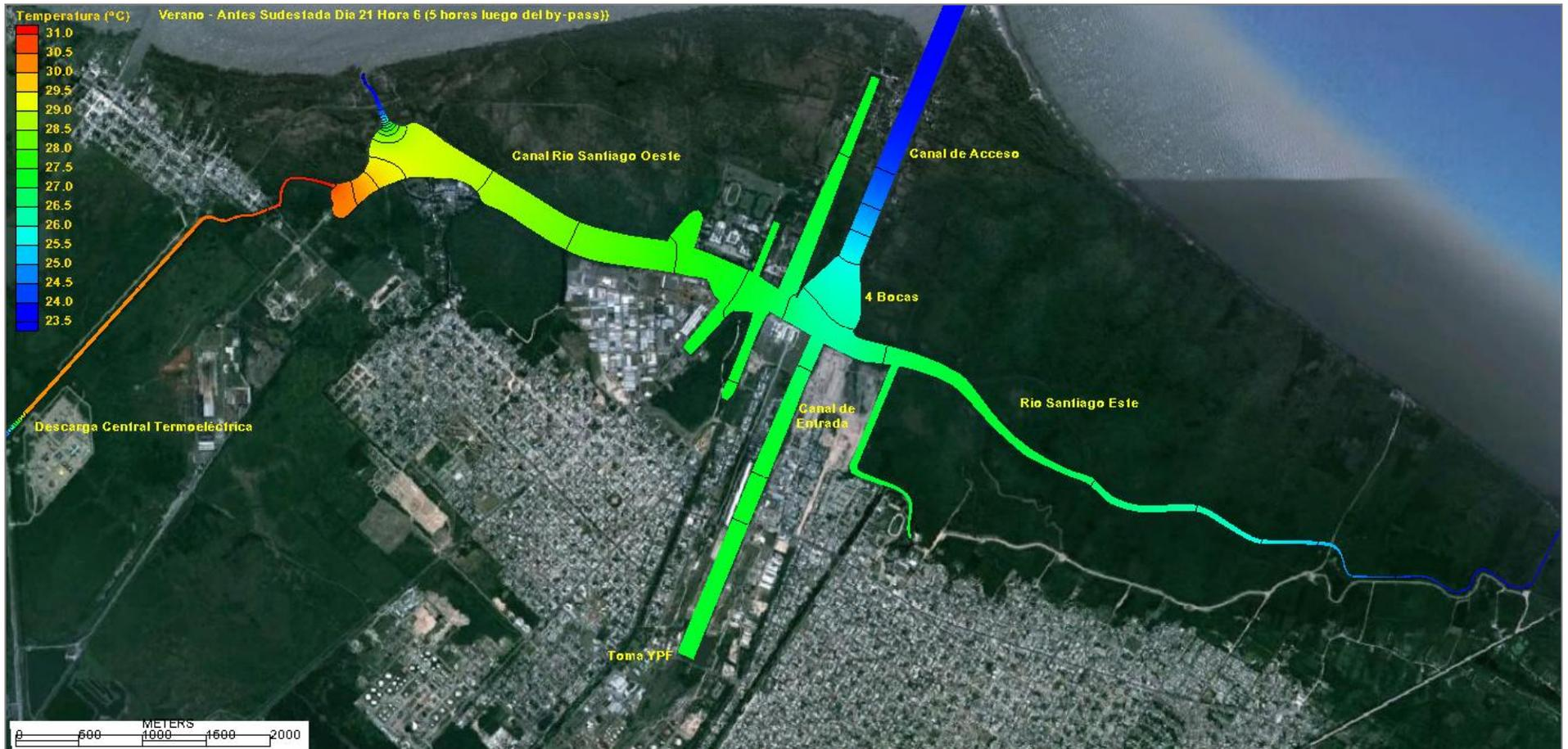
**Figura 53.** Descarga de agua con Incremento de Temperatura 7,5°C - Marea astronómica con Sudestada. Escenario de Verano (temp. de equilibrio 23,5°C) y Coeficiente de Transferencia de calor mínimo. Campo de temperaturas típico antes del pico de la sudestada (en marea creciente) 5 horas después de la descarga en bypass de turbina con Incremento de Temperatura 11,5°C durante 1 hora.
