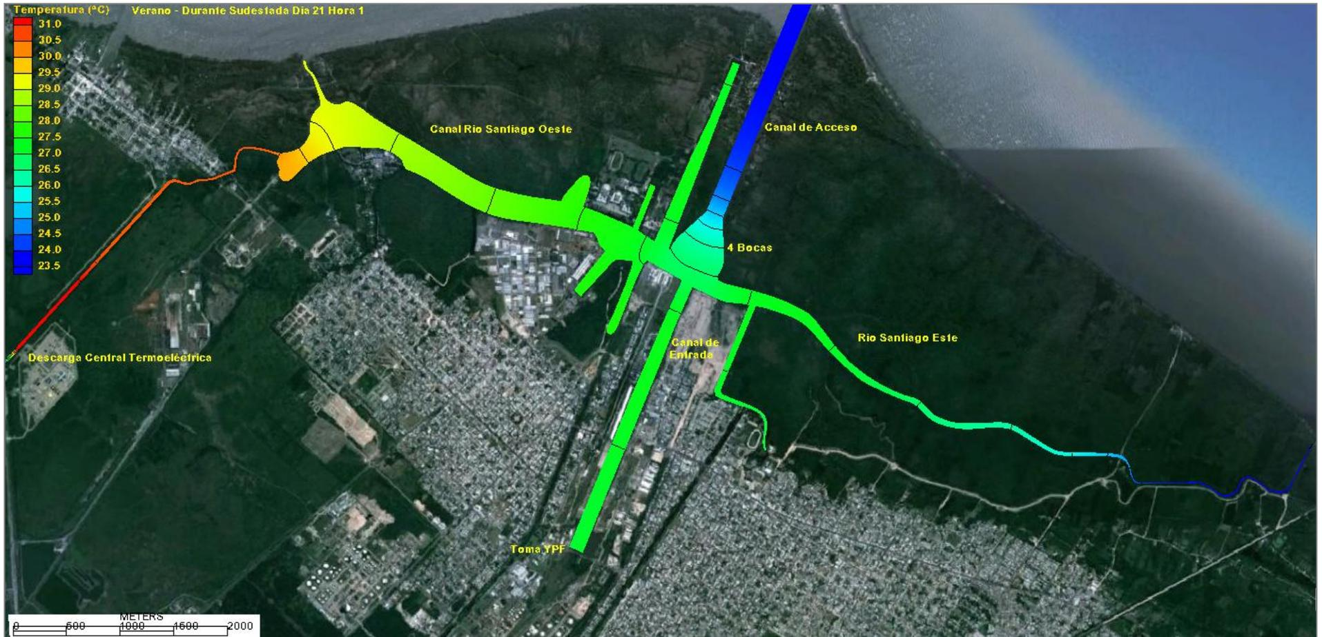
**Figura 52.** Descarga de agua con Incremento de Temperatura 7,5°C - Marea astronómica con Sudestada. Escenario de Verano (temp. de Equilibrio 23,5°C) y Coeficiente de Transferencia de calor mínimo. Campo de temperaturas típico durante la Sudestada (en su inicio) y después de una segunda descarga en bypass de turbina con Incremento de Temperatura 11,5°C durante 1 hora (segundo bypass en 24 horas).
