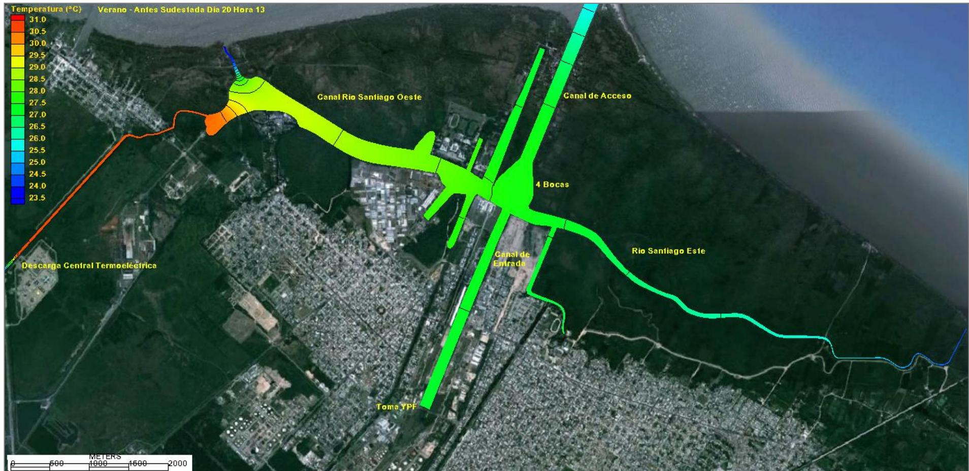
**Figura 51.** Descarga de agua con Incremento de Temperatura 7,5°C - Marea astronómica con Sudestada. Escenario de Verano (temp. de equilibrio 23,5°C) y Coeficiente de Transferencia de calor mínimo. Campo de temperaturas típico antes de la Sudestada y 12 horas después de una descarga en bypass de turbina con Incremento de Temperatura 11,5°C durante 1 hora (primer bypass en 24 horas).
