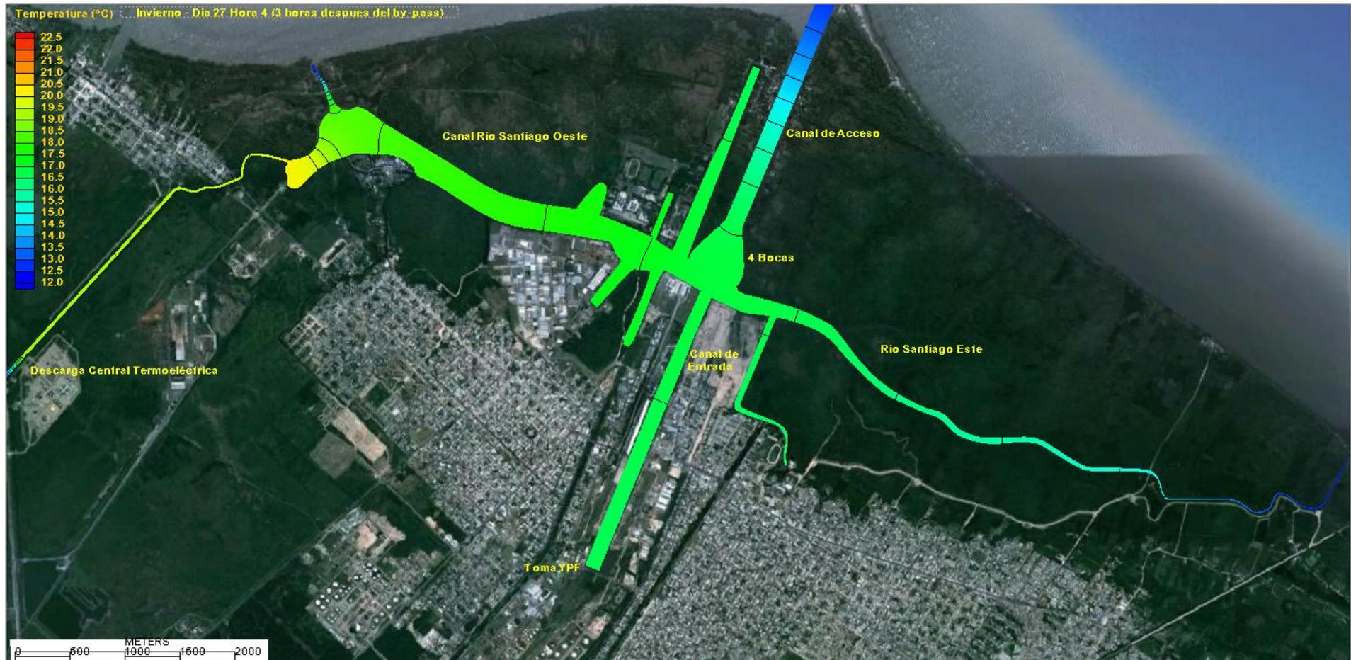
**Figura 41.** Descarga de agua con Incremento de Temperatura 7,5°C - Marea media. Escenario de Invierno (temp. de equilibrio 12,2°C) y Coeficiente de Transferencia de calor mínimo. Campo de temperaturas tres horas después de la descarga en bypass de turbina con Incremento de Temperatura 11,5°C durante 1 hora.
