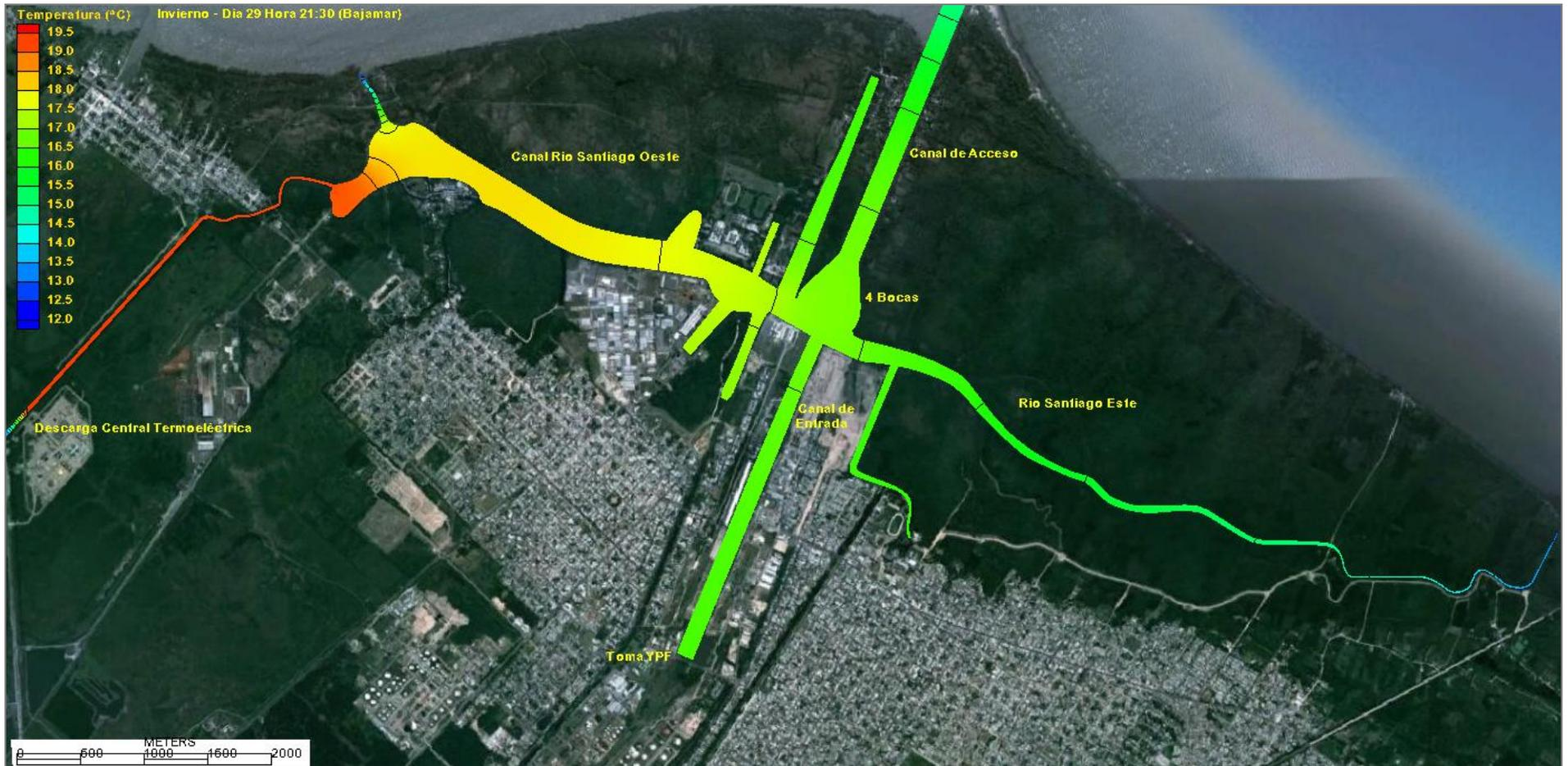
**Figura 45.** Descarga de agua con Incremento de Temperatura 7,5°C - Marea media. Escenario de Invierno (temp. de Equilibrio 12,2°C) y Coeficiente de Transferencia de calor máximo. Campo de temperaturas típico en cercanías de una Bajamar.
