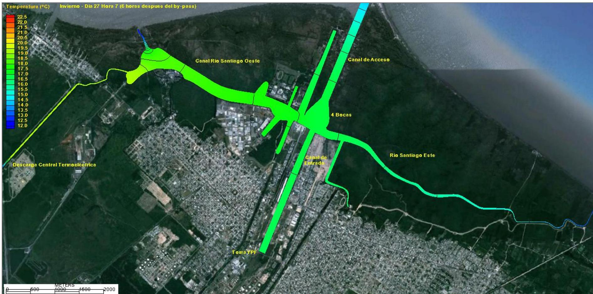
**Figura 42.** Descarga de agua con Incremento de Temperatura 7,5°C - Marea media. Escenario de Invierno (temp. de equilibrio 12,2°C) y Coeficiente de Transferencia de calor mínimo. Campo de temperaturas seis horas después de la descarga en bypass de turbina con Incremento de Temperatura 11,5°C durante 1 hora.
