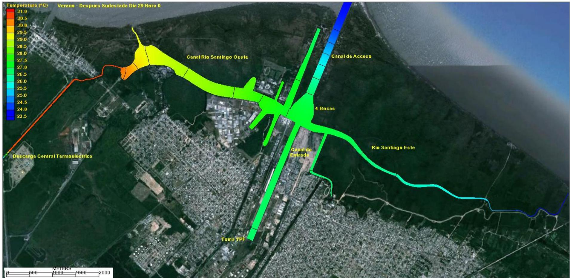
**Figura 56.** Descarga de agua con Incremento de Temperatura 7,5°C – Marea Astronómica. Escenario de Verano (temp. de equilibrio 23,5°C) y Coeficiente de Transferencia de calor mínimo. Campo de temperaturas típico durante una marea astronómica 6 días después de una Sudestada.
