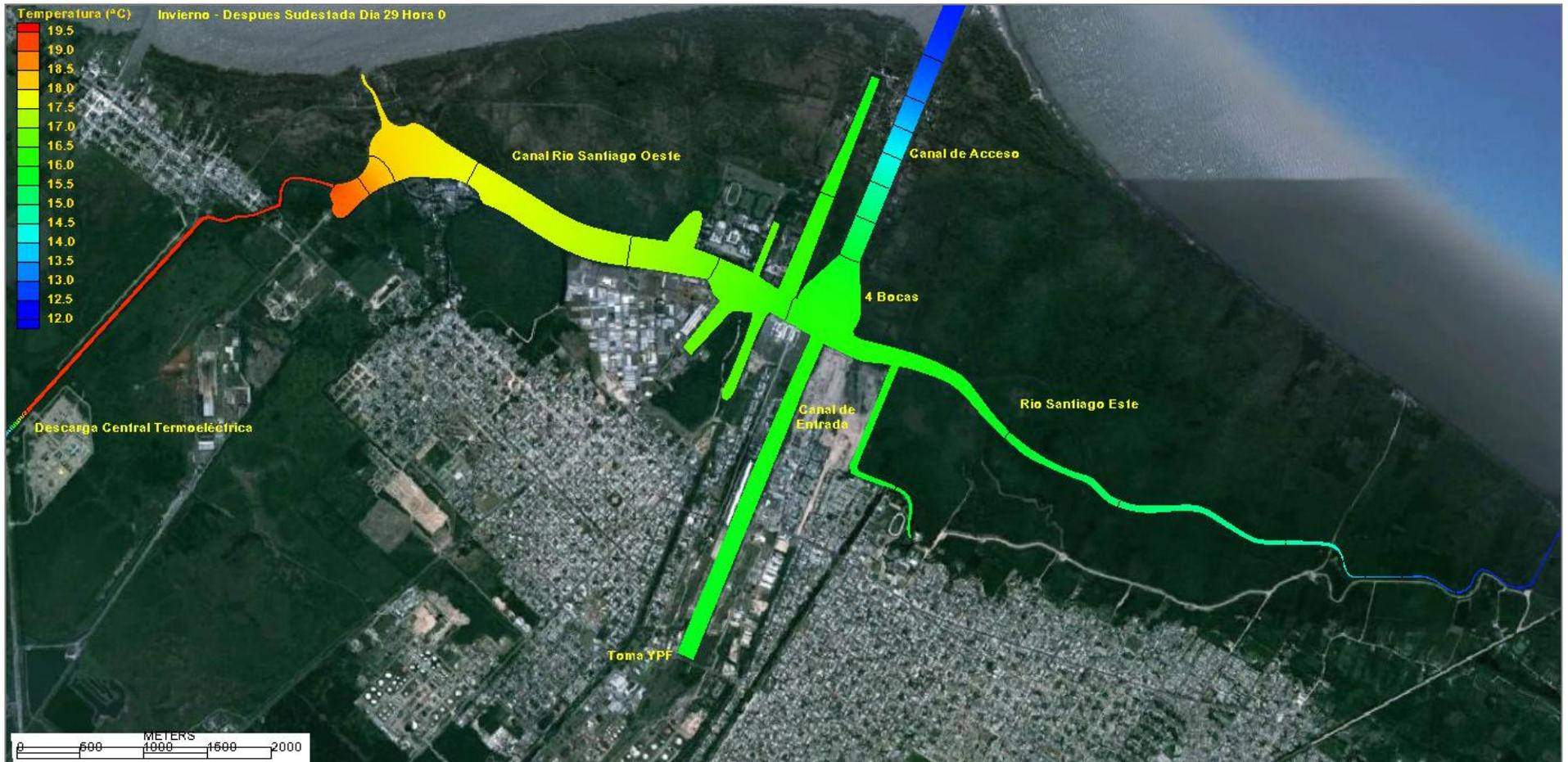
**Figura 49.** Descarga de agua con Incremento de Temperatura 7,5°C - Marea astronómica con Sudestada. Escenario de Invierno. Temperatura de Equilibrio 12,2°C. Coeficiente de Transferencia de calor mínimo. Campo de temperaturas típico durante una marea astronómica 6 días después de una sudestada.
