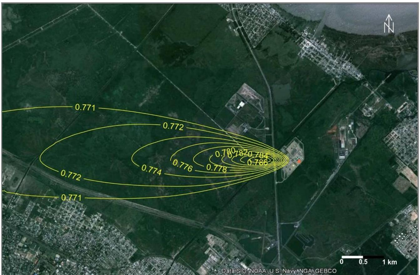
**Figura 2.** Isopletras de concentración media en mg/m<sup>3</sup> (tiempo promedio 8 horas) de CO en aire a nivel del suelo. Combustible: gas natural. (10/01/05; 01:00 hs). ▲ Chimenea 01.
