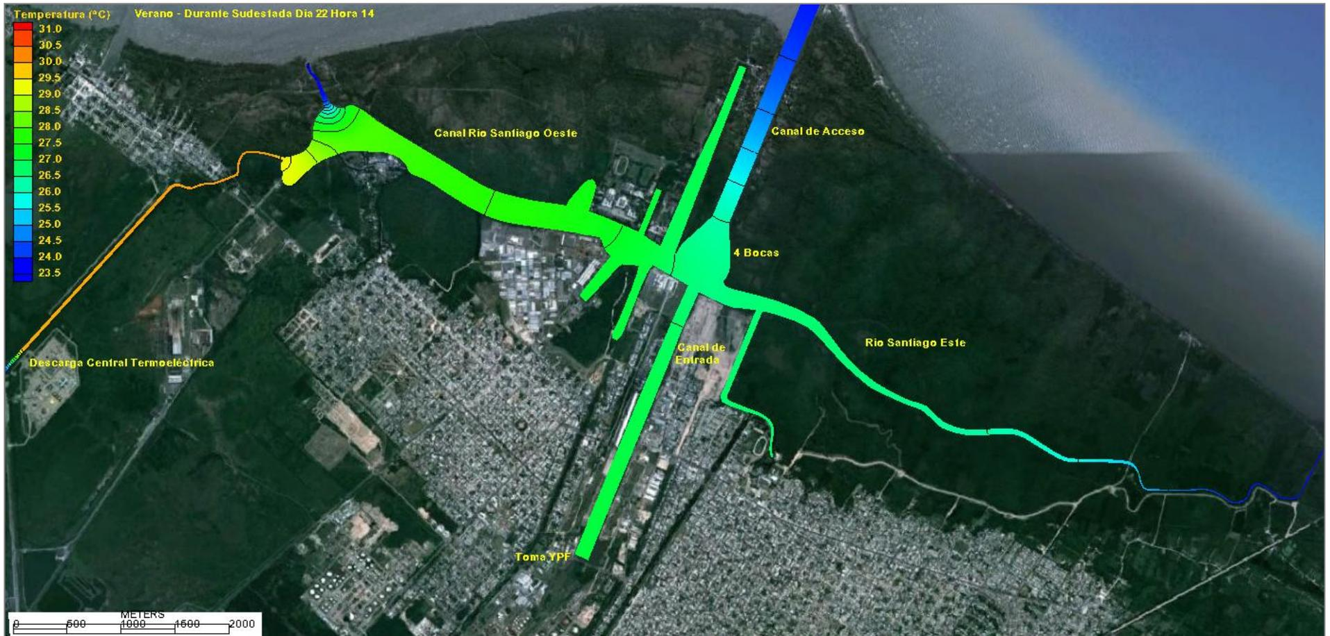
**Figura 55.** Descarga de agua con Incremento de Temperatura 7,5°C - Marea astronómica con Suddestada. Escenario de Verano (temp. de equilibrio 23,5°C) y Coeficiente de Transferencia de calor mínimo. Campo de temperaturas típico durante el pico de pleamar de la Suddestada.
