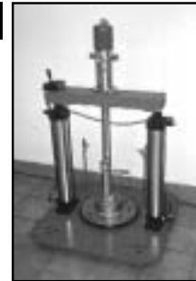
Dispositivo neumático para bombeo de productos viscosos.
